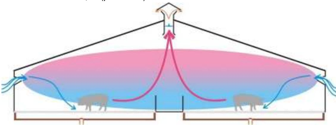
Рисунок 2.31 — Неправильная настройка приточных клапанов
