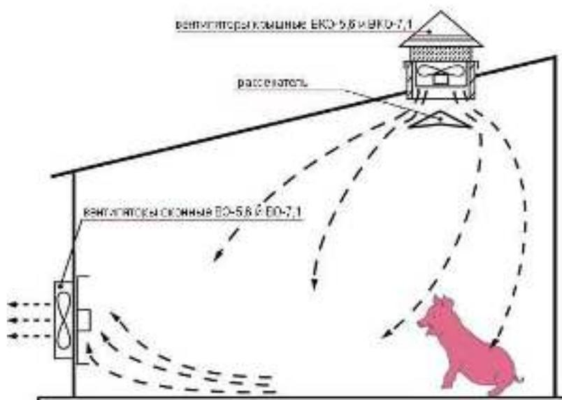
Рисунок 2.32 — Равновесная система вентиляции
