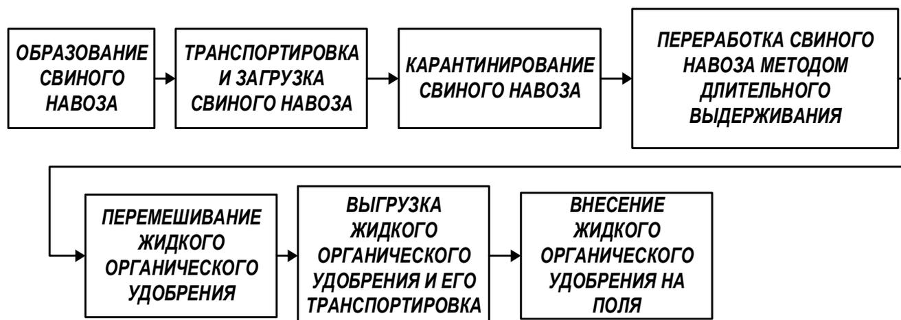
Рисунок 2.61 — Блок-схема технологии переработки свиного навоза в органическое удобрение методом длительного выдерживания
