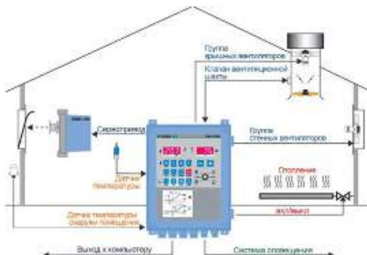
Рисунок 2.34 — Система управления микроклиматом
