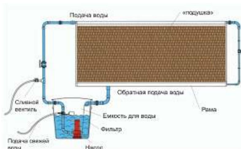
Рисунок 2.20 – Принципиальная схема охлаждающей системы через увлажненные перфорированные бумажные «подушки»
