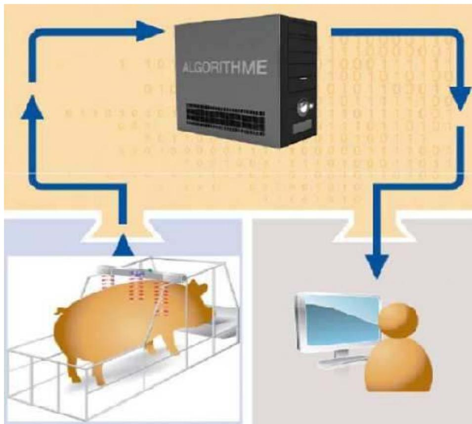
Рисунок 7.2 – Схема работа системы анализа половой охоты свиноматок
