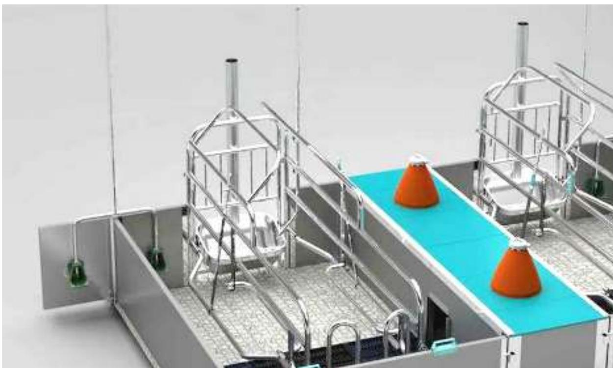
Рисунок 2.8 — Фиксатор для содержания подсосных свиноматок
