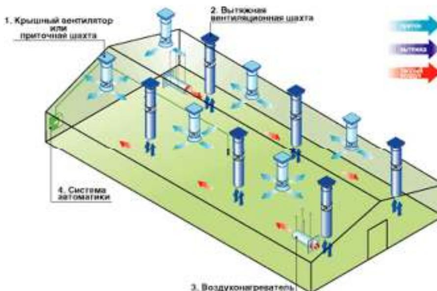
Рисунок 2.36 — Равновесная система вентиляции с удлиненными вытяжными шахтами
