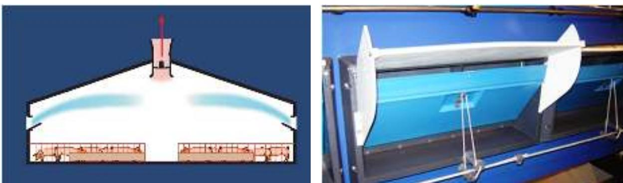
Рисунок 2.29 — Пример системы вентиляции с приточными клапанами
