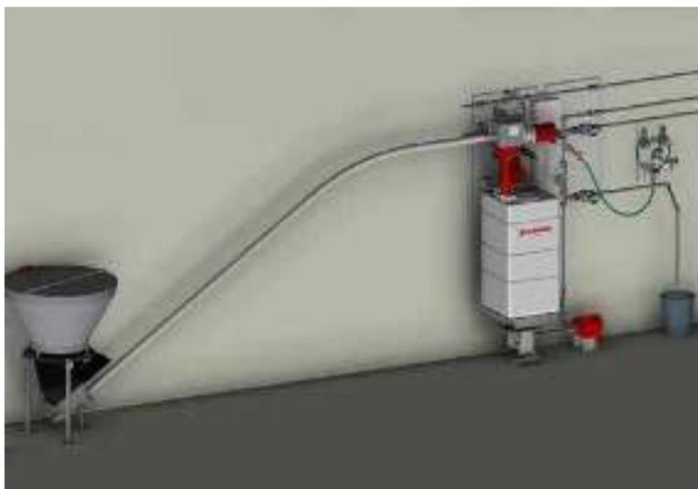
Рисунок 7.4 – Система кормления поросят-сосунов
