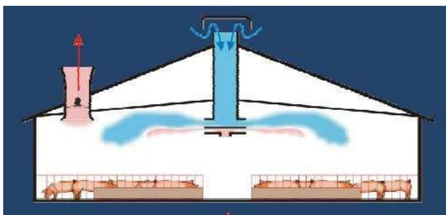
Рисунок 2.35 — Вентиляция с притоком и вытяжкой воздуха через крышу
