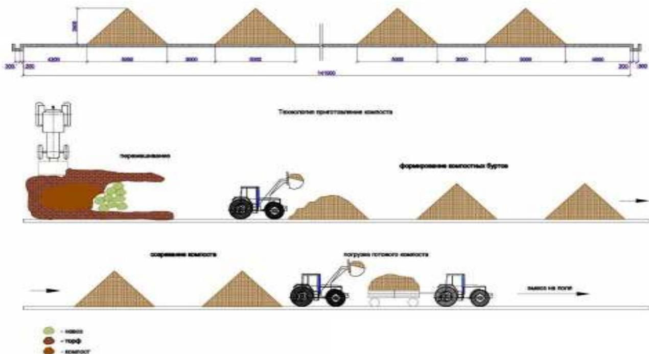
Рисунок 2.68 — Бетонированная площадка компостирования [62]
