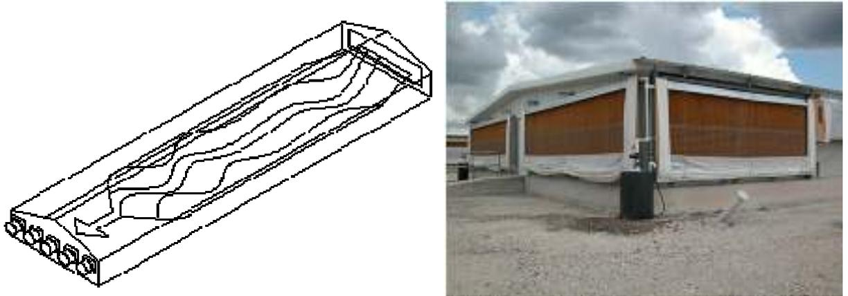
Рисунок 2.21 — Схема движения воздуха в здании для откорма молодняка
