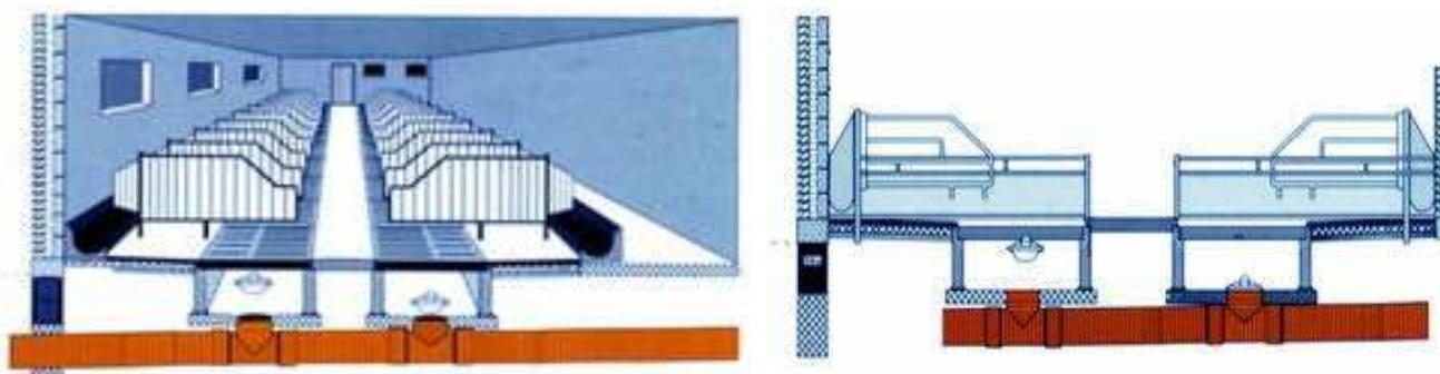
Рисунок 2.52 — Устройство навозных ванн
