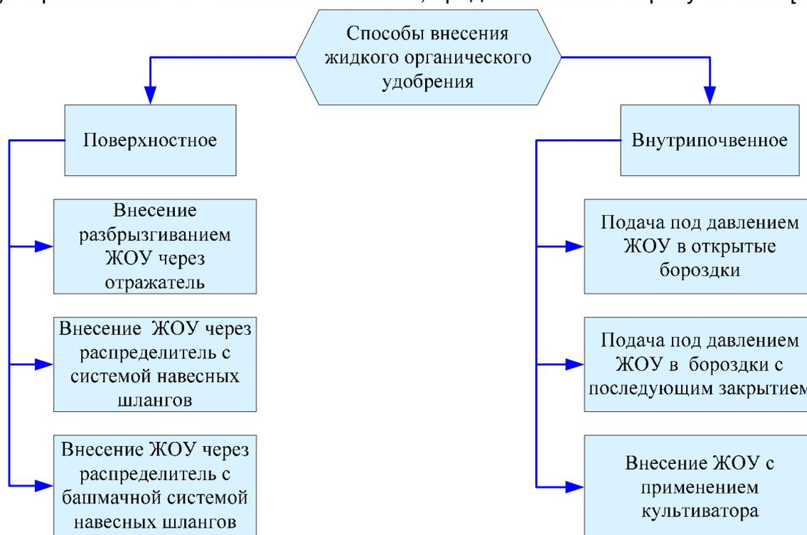
Рисунок 2.70 — Способы внесения жидкого органического удобрения
