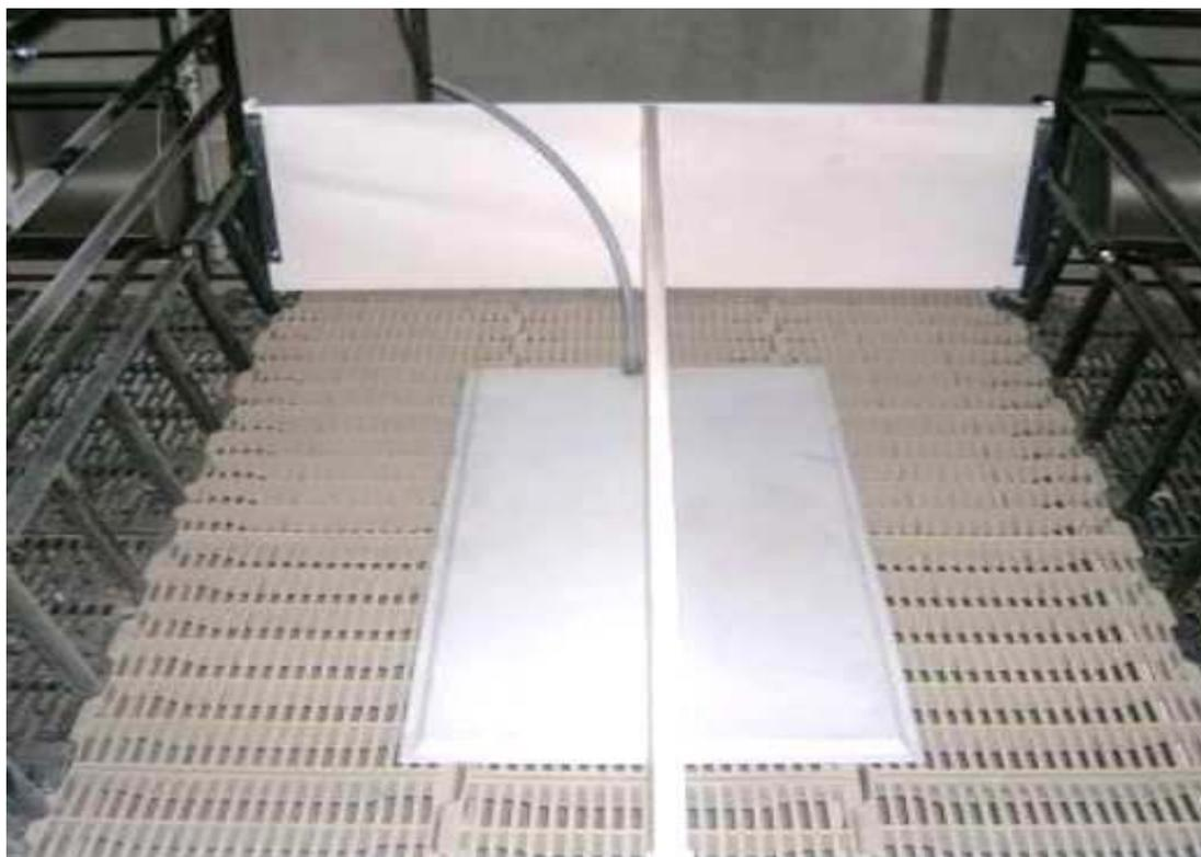
Рисунок 2.10 — Подогреваемый электрический коврик
