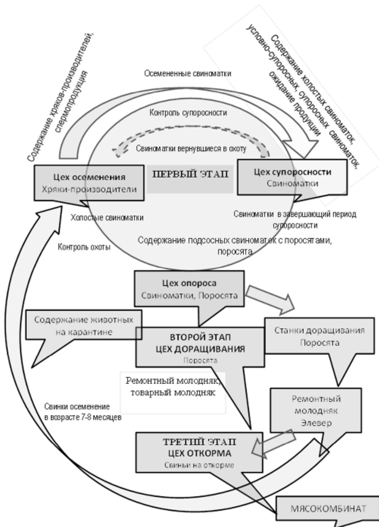
Рисунок 5.1.1 — Общая схема описания технологического процесса
