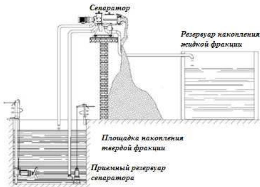
Рисунок 2.65 — Схема разделения свиного навоза на фракции
