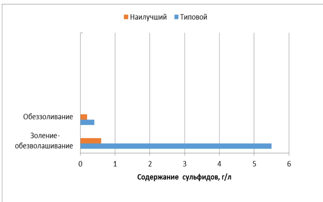
Рисунок 3.4 — Сравнительная концентрация сульфидов в отработанных растворах, г/л
