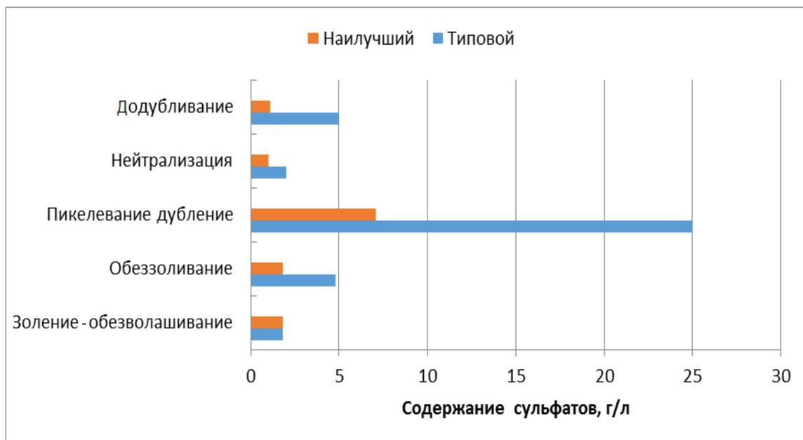
Рисунок 3.3 — Сравнительная концентрация сульфатов в отработанных растворах, г/л
