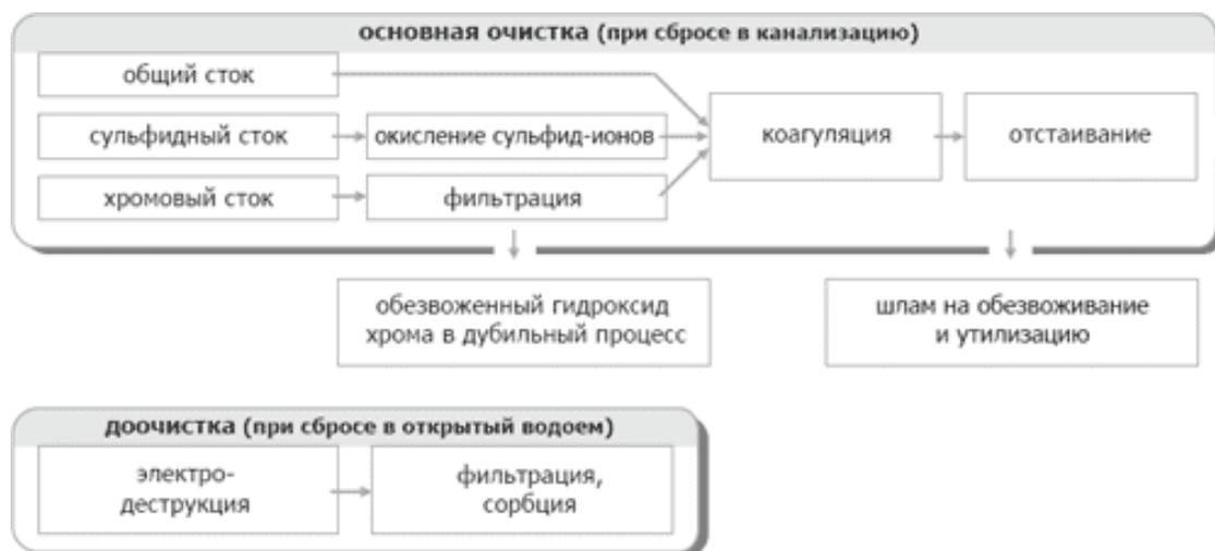
Рисунок 4.3 — Схема физико-химической обработки стоков
