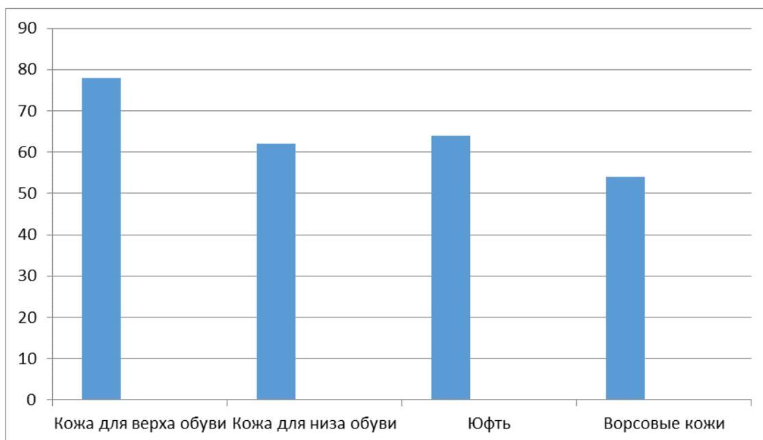
Рисунок 4.1 — Расход воды на технологические нужды на 1 т сырья в зависимости от ассортимента выпускаемой продукции, м<sup>3</sup>
