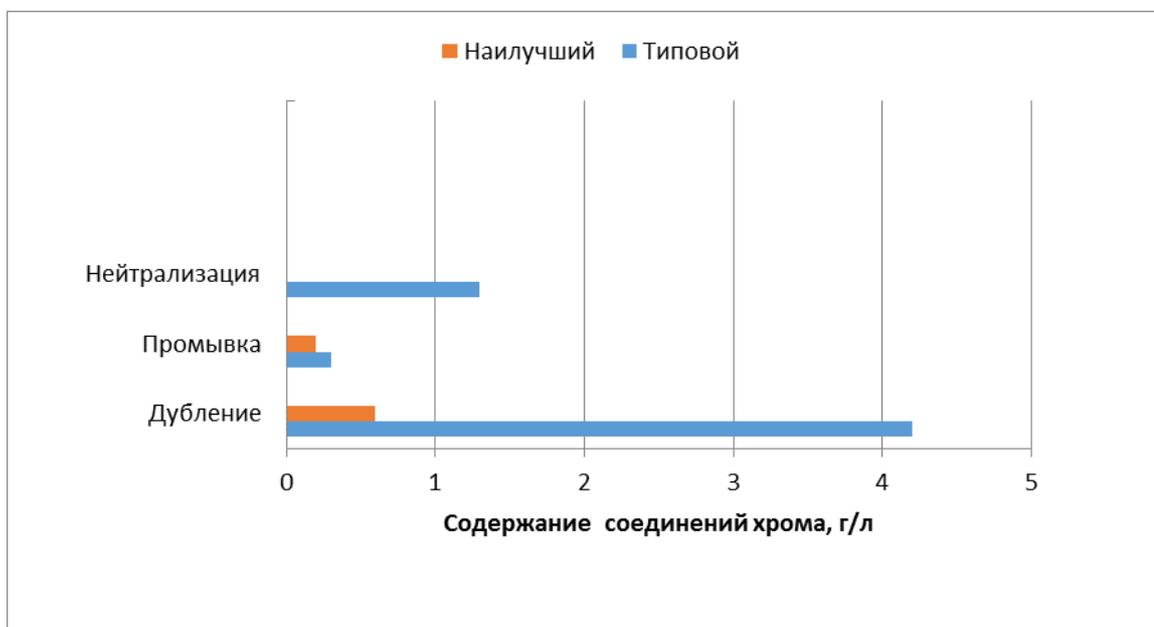
Рисунок 3.6 — Содержание соединений хрома (III) в отработанных растворах
