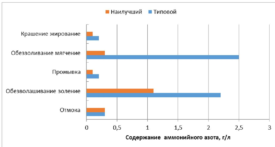
Рисунок 3.5 — Сравнительная концентрация аммонийного азота в отработанных растворах, г/л
