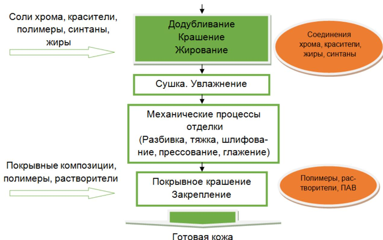
Рисунок 2.3 — Потребляемые химические вещества и характеристика стоков
