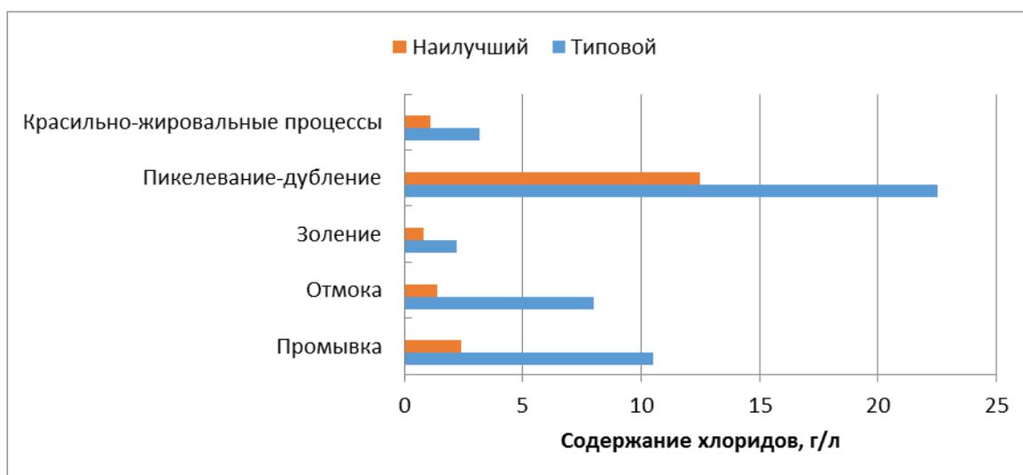
Рисунок 3.2 — Сравнительная концентрация хлоридов в отработанных растворах, г/л
