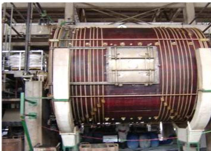
Рисунок 2.2 — Барабан для отмочно-зольных процессов
