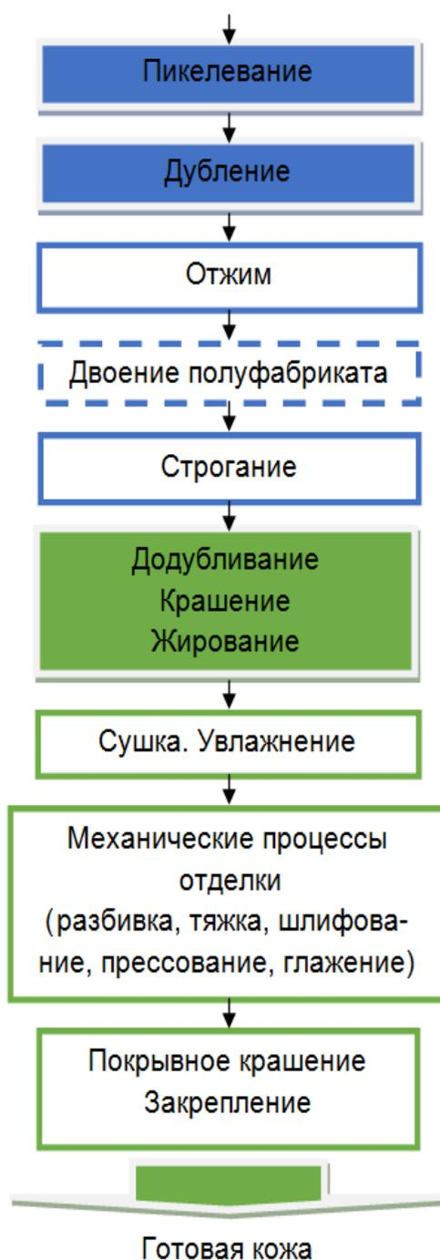
Рисунок 2.1 — Схема технологического процесса производства кож хромового дубления
