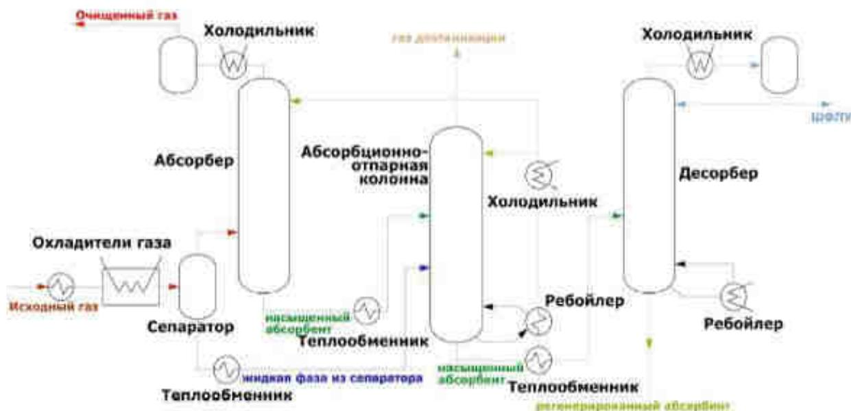
Рисунок 2.20 – Типовая схема установки масляной абсорбции
