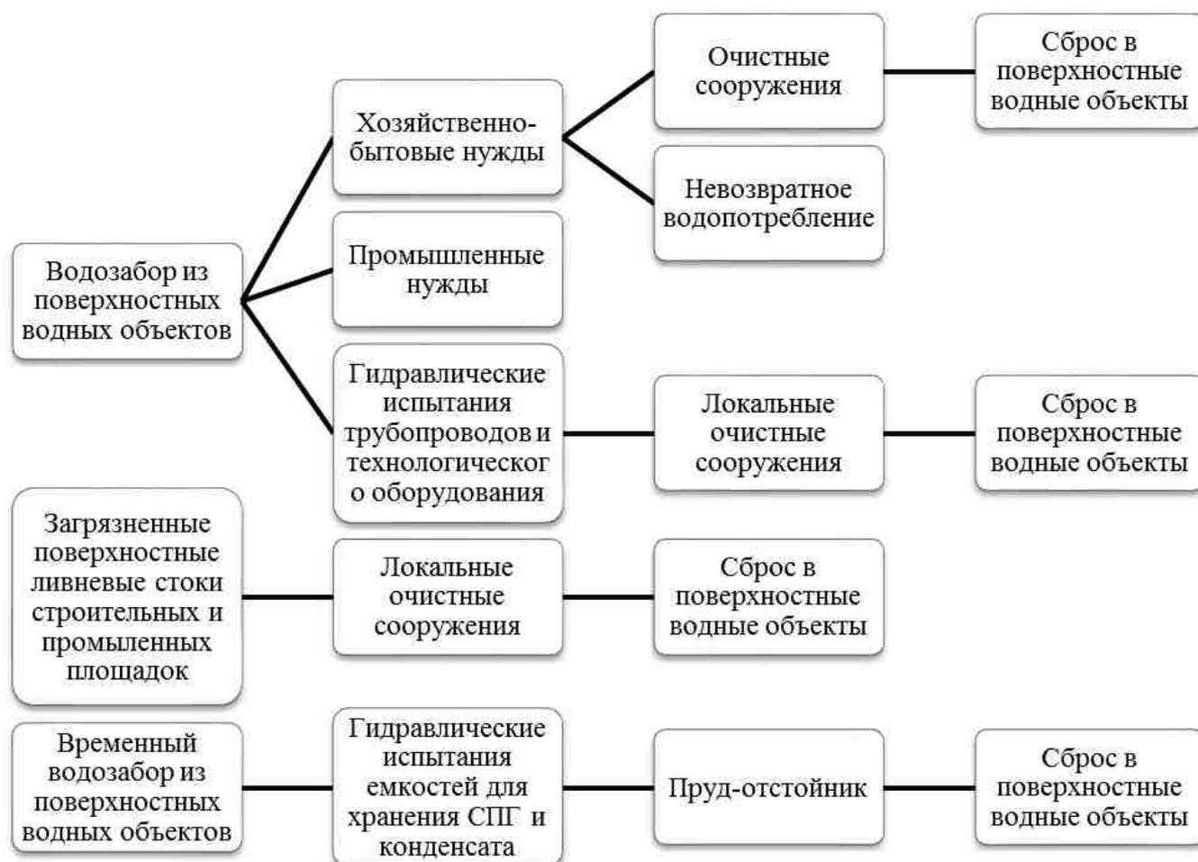
Рисунок 3.5 – Организация временного водоснабжения и пути отвода сточных вод на этапе строительства [58]
