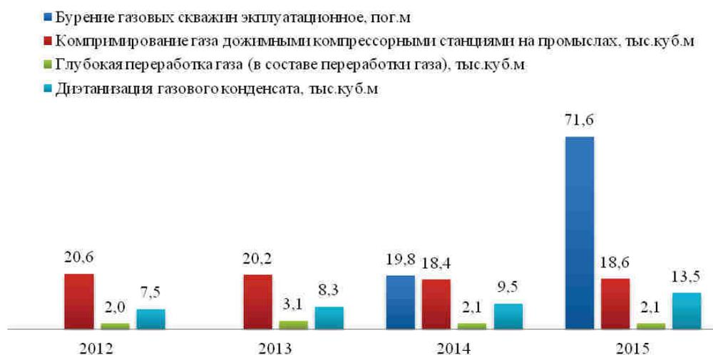
Рисунок 3.3 – Фактический расход топлива на единицу отдельных видов произведенных продукции, работ по РФ
