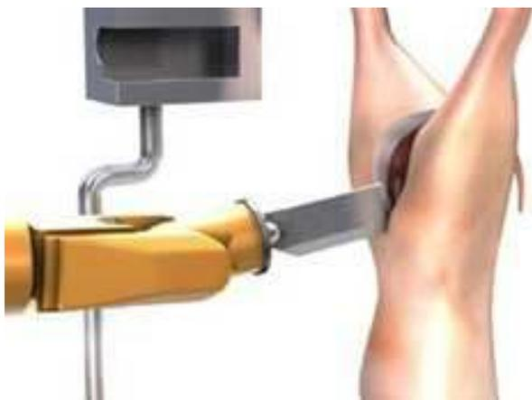
Рис. 2.153 Комбинированный робот для вскрытия лонной кости, брюшка и грудины
