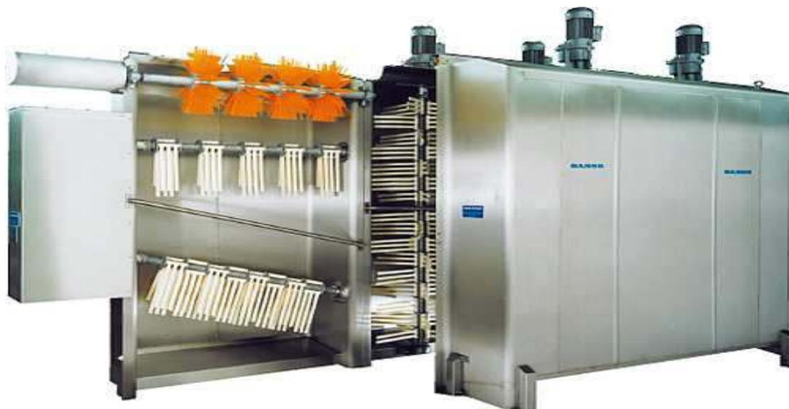
Рис. 2.141 Машины предварительной зачистки, мойки и сушки туш
