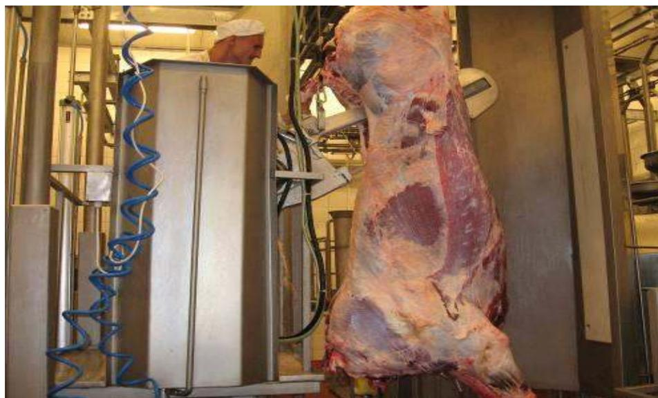
Рис. 2.113. Подъемно-опускная площадка для распиловки туш
