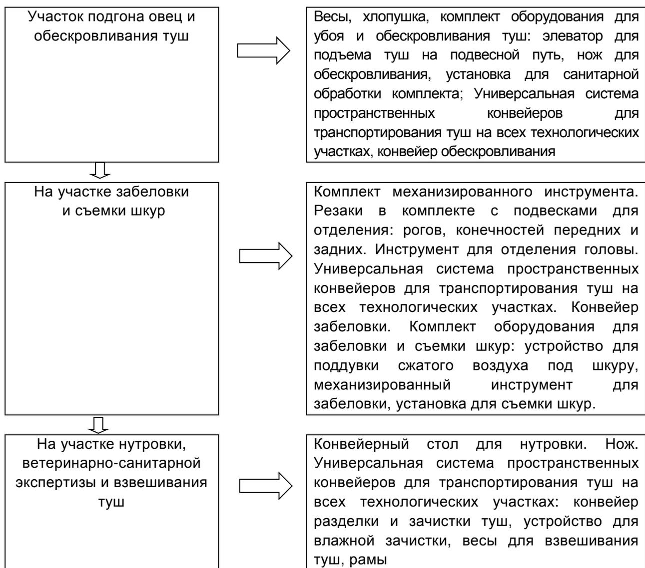
Рис.2.17 Схема использования оборудования на различных участках процесса переработки овец и коз
