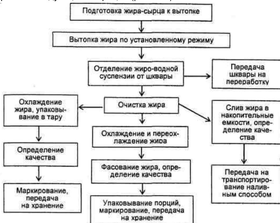
Рис. 2.65 Технологическая схема производства пищевого жира из жира-сырца
