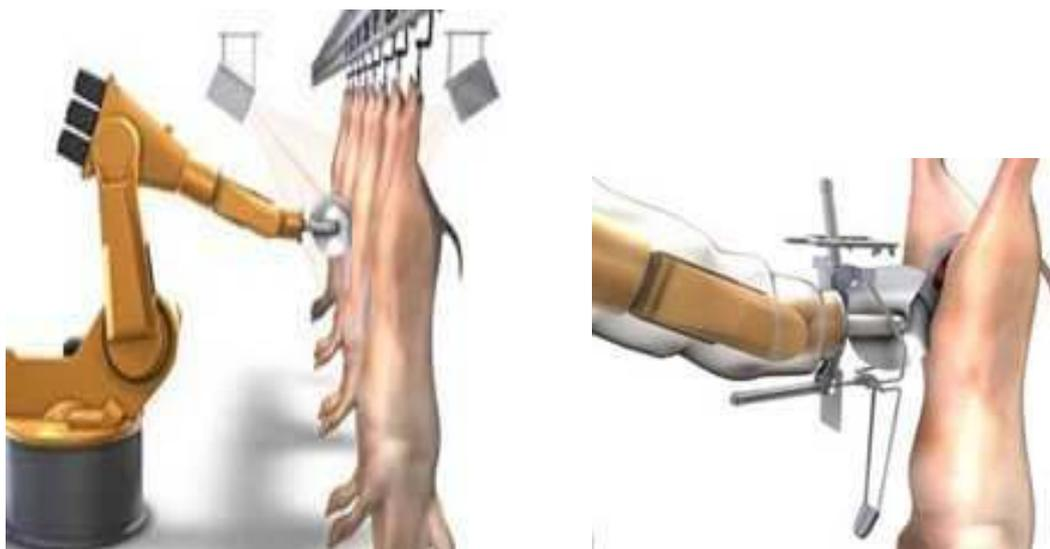
Рис. 2.150. Роботизированная система разрезания мышц живота перед нутровкой
