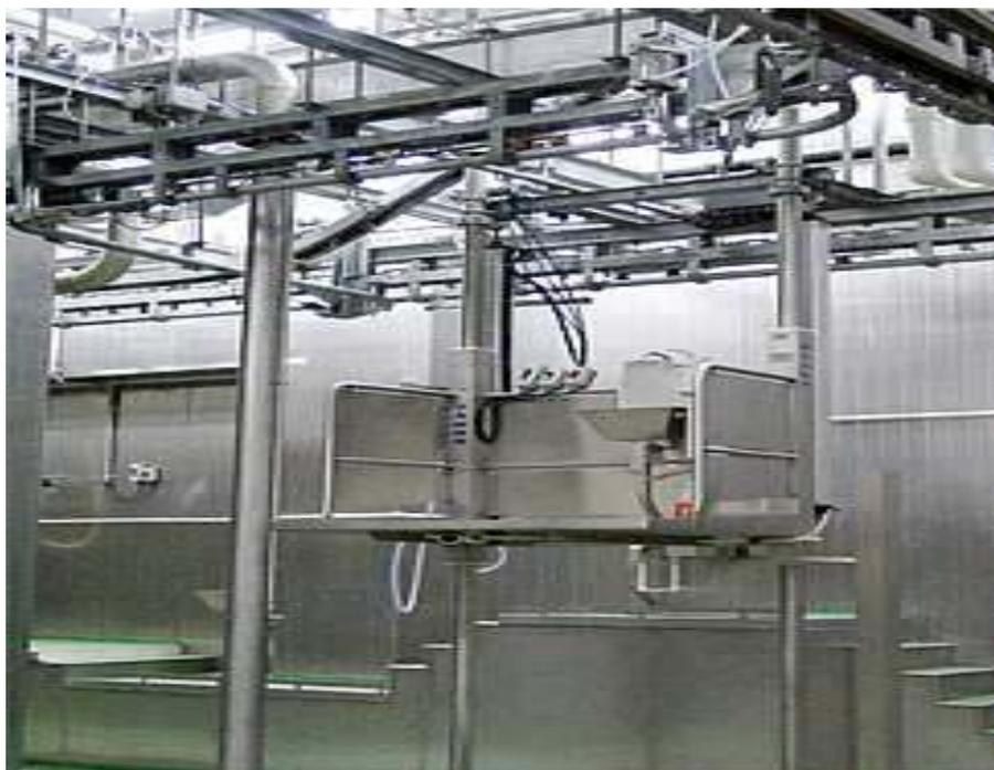
Рис. 2.99 Автоматическая установка для распиловки туш КРС
