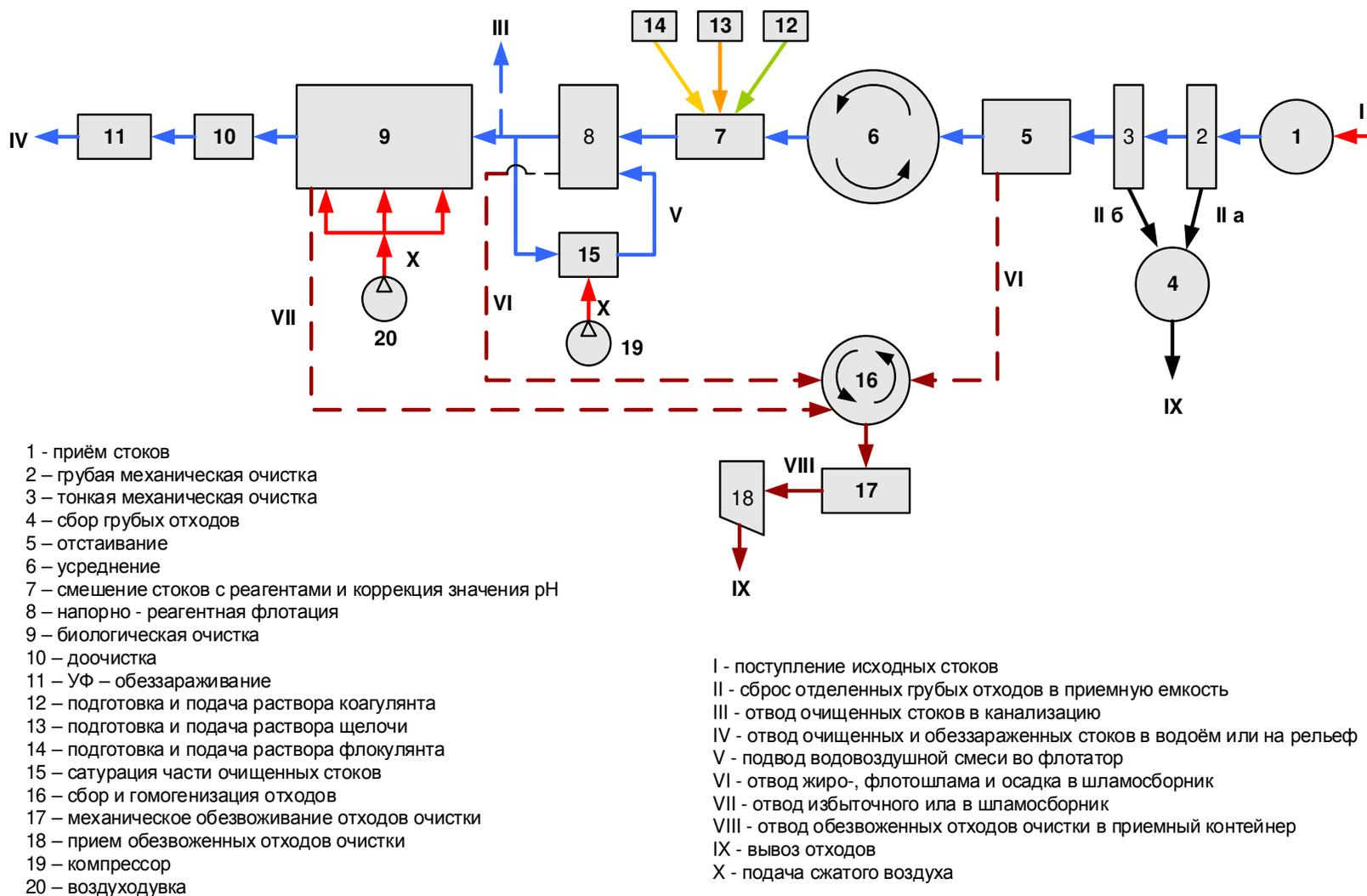
Рис. 1. Блок-схема процессов очистки сточных вод мясокомбината.
