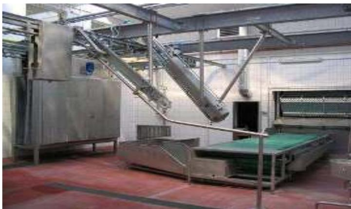
Рис. 2.124 Бокс для оглушения свиней при помощи газа CO<sub>2</sub>
