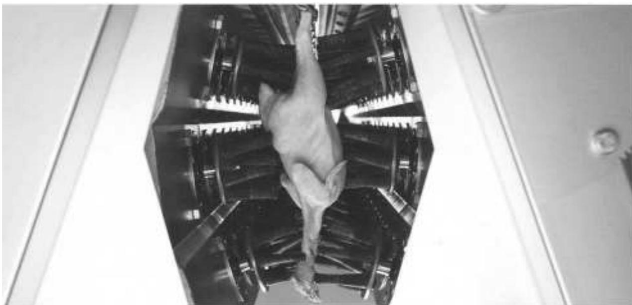
Рис. 2.38 Обработка птицы в аппарате для удаления пера
