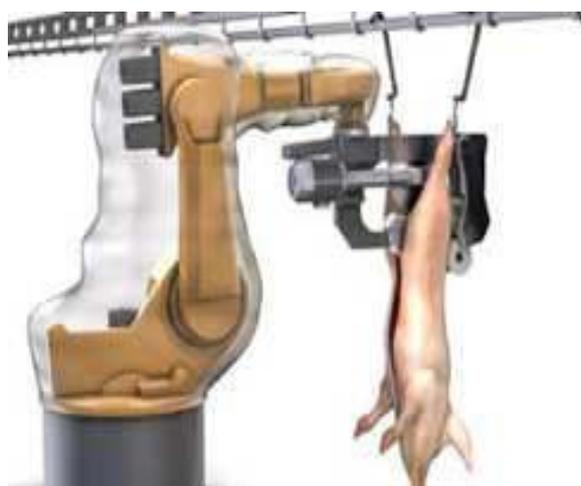
Рис. 2.154 Робот для разуба и распиловки туш на полутуши
