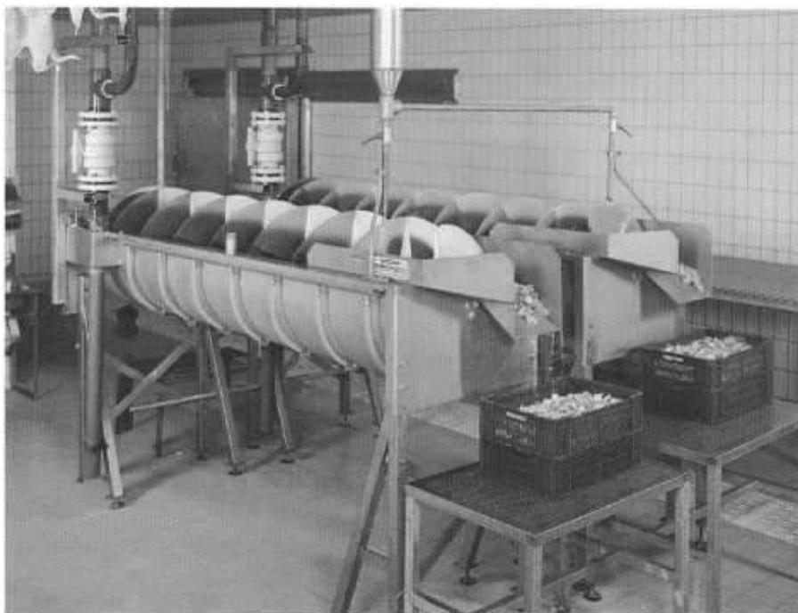
Рис. 2.44 Водяной охладитель с противотоком
