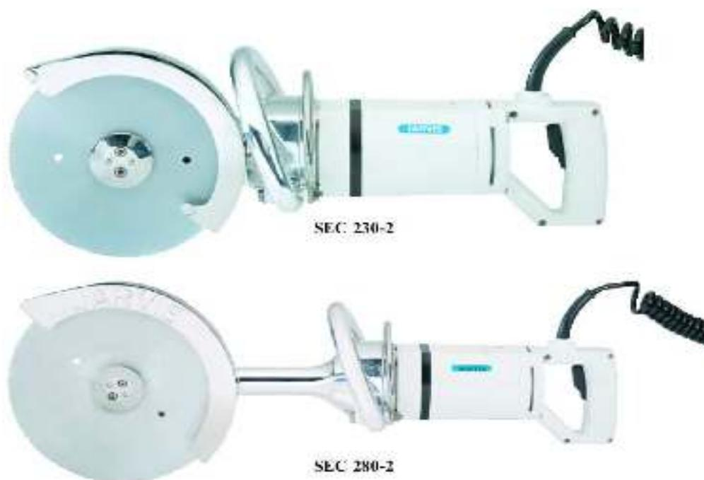
Рис. 2.146. Дисковые пилы для разделки полутуш и четвертин
