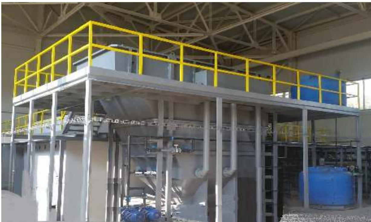
Рис. 2.78. Напорный реагентный флотатор.
