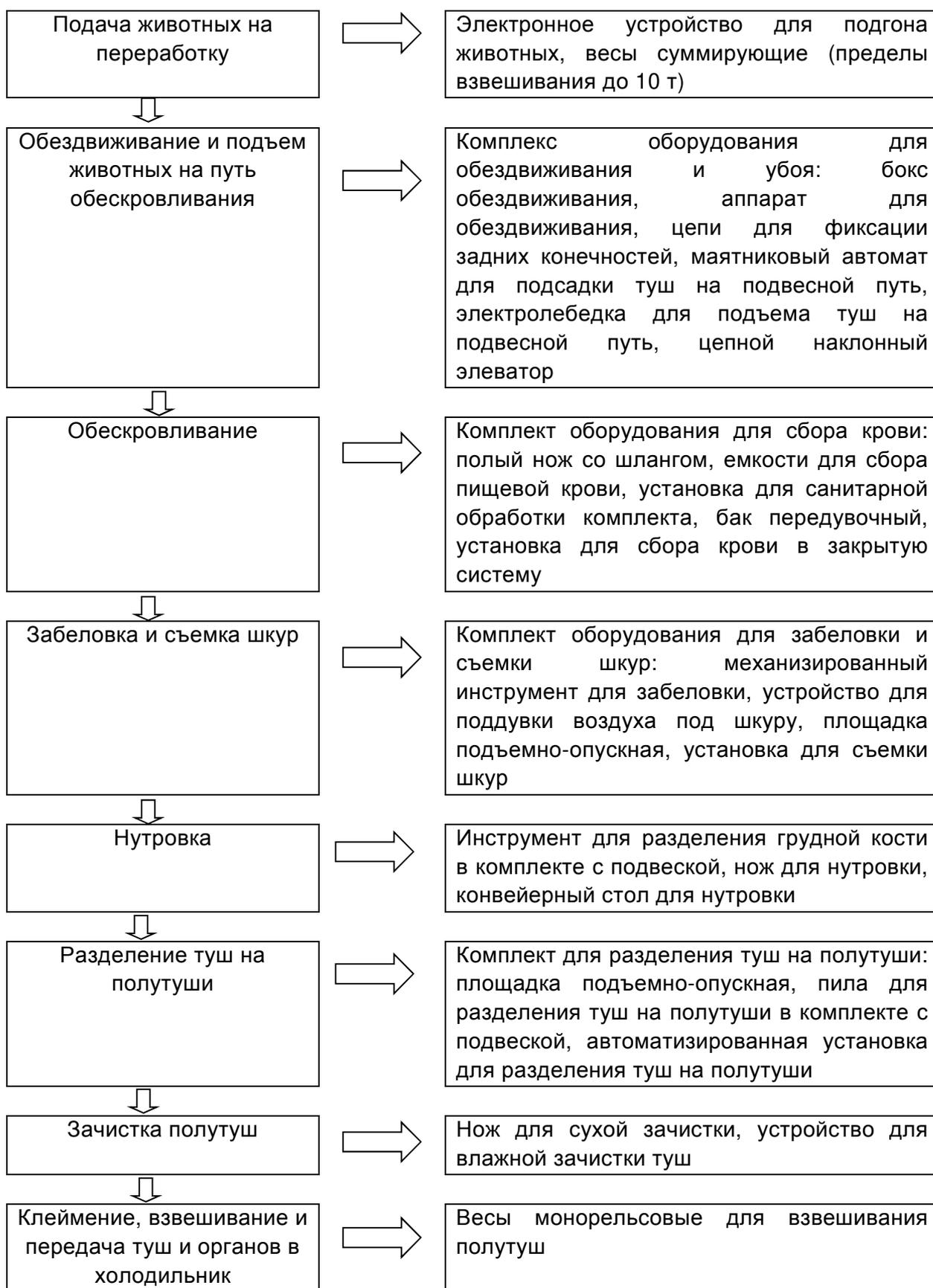
Рис. 2.4 Схема использования оборудования на различных участках процесса переработки крупного рогатого скота [ 72 ]
