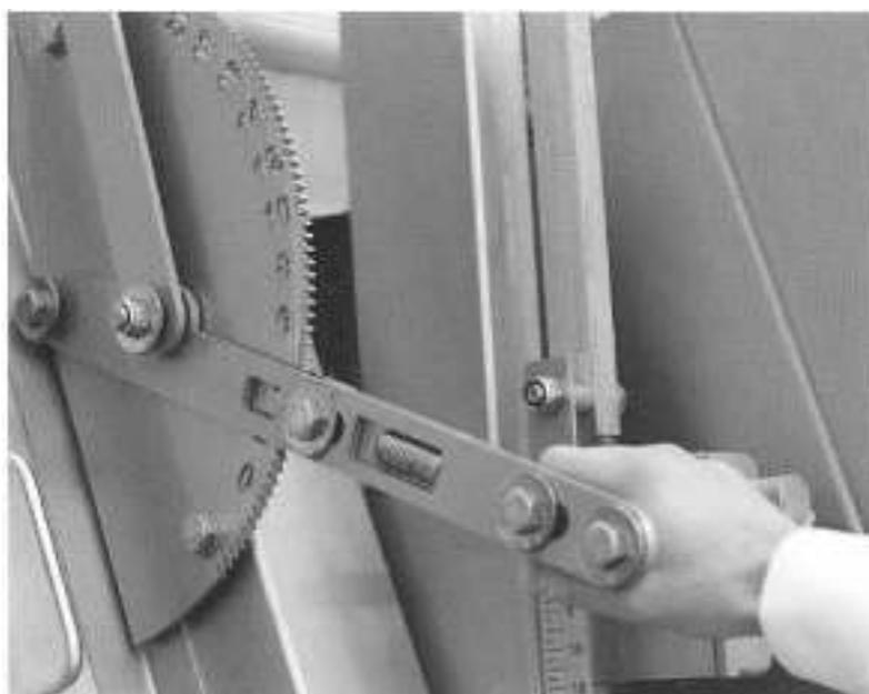
Рис. 2.40 Регулировка устройств обесперивания
