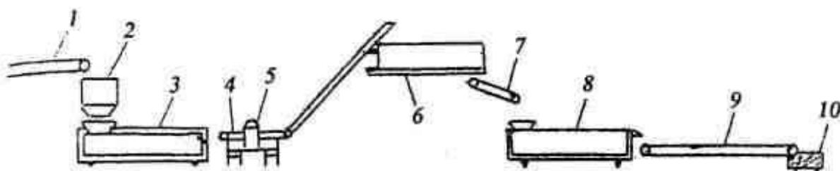
Рис. 2.51 Схема оборудования технологического участка обработки шерстных субпродуктов на мясокомбинатах мощностью 50-100 т мяса в смену:
