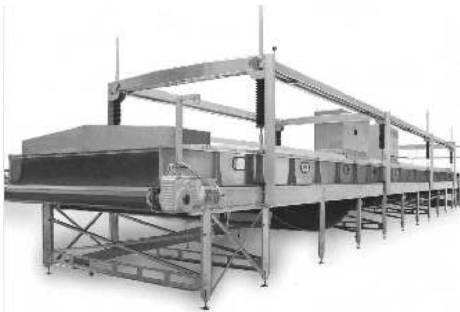
Рис.2.27 Система оглушения газовой смесью
