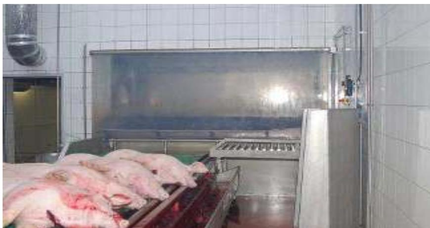
Рис. 2.126. Конвейерный стол для обескровливания животных
