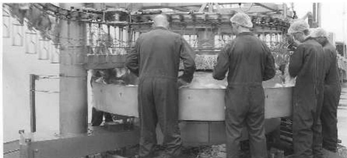
Рис. 2.23 Подвешивание птицы в цехе переработки
