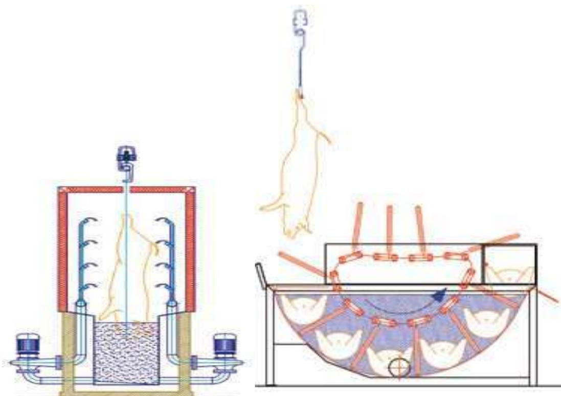
Рис. 2.138 Чан горизонтальный для ошпарки свиней
