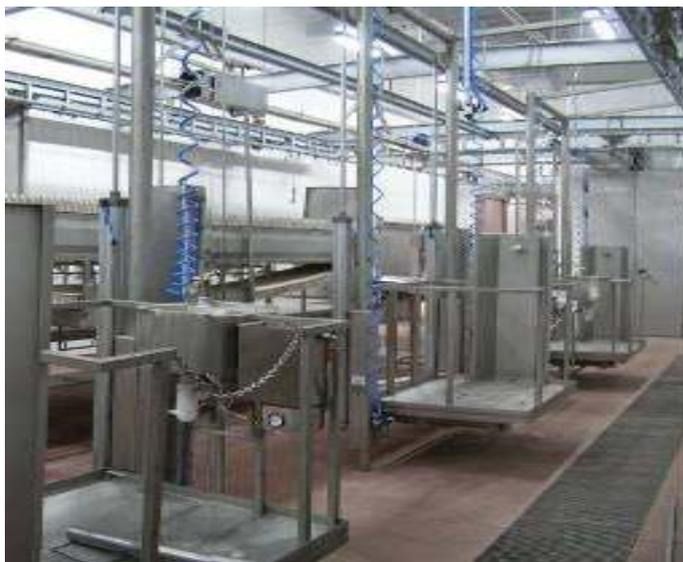
Рис. 2.107 Пневматическая подъемно-опускная площадка
