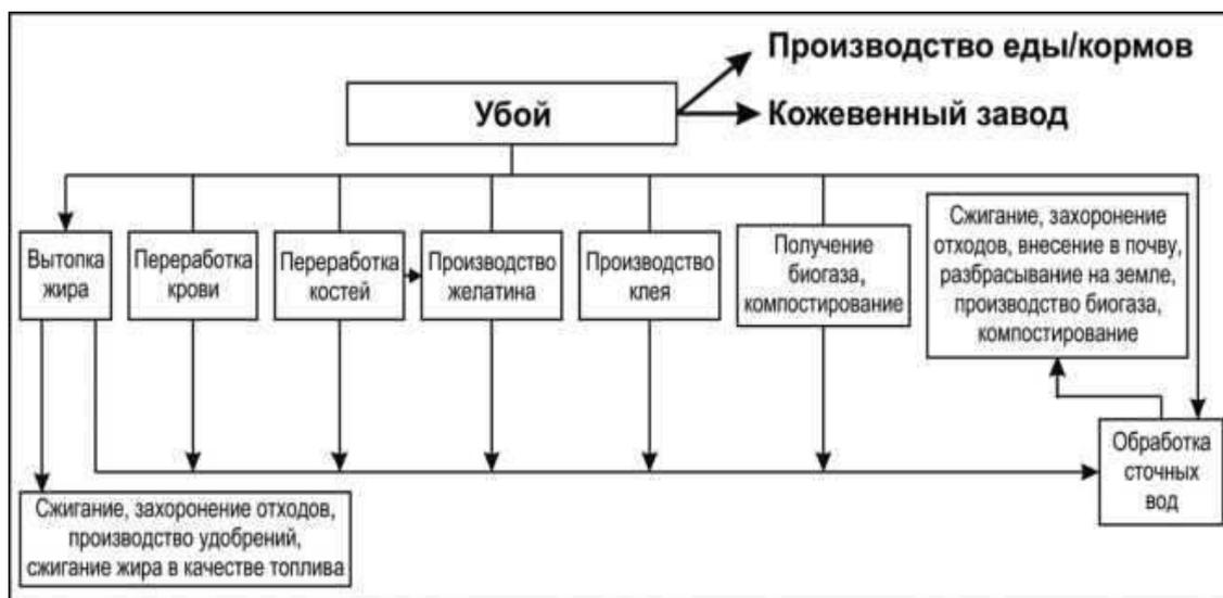
Рис. 3.1. Схема переработки побочных продуктов убоя животных
