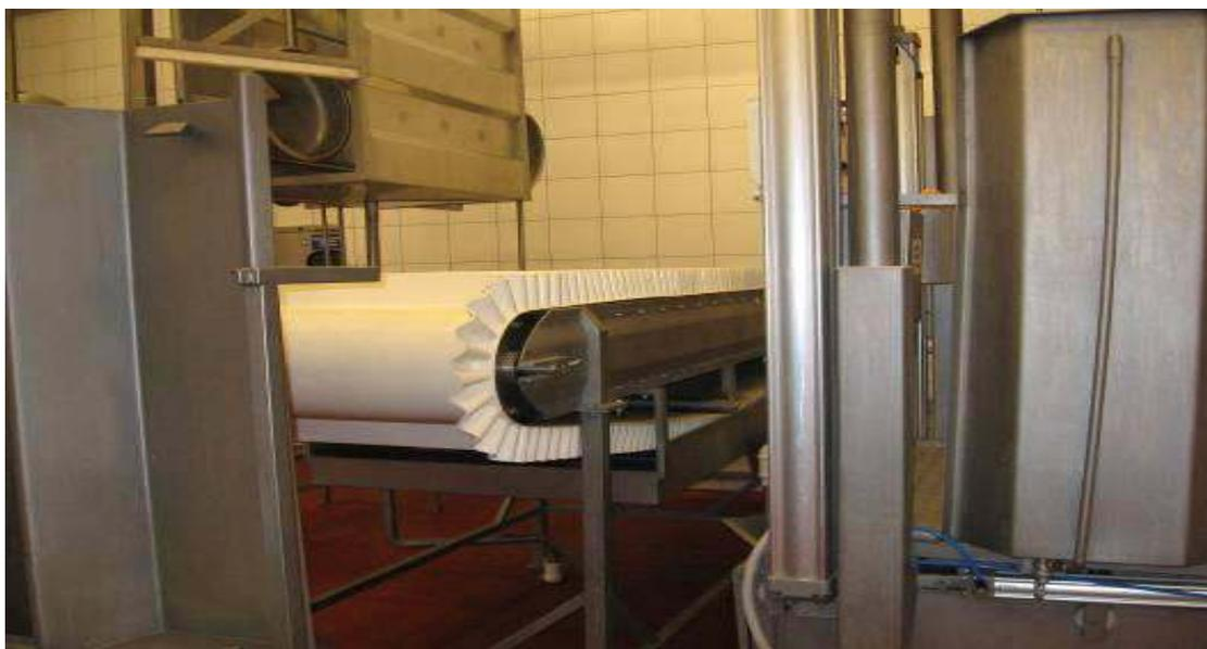
Рис. 2.115. Ленточный конвейер для обработки кишечного сырья
