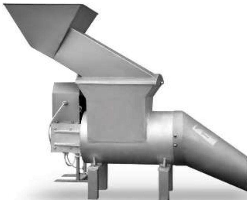
Рис. 2.118. Шнековая дробилка отходов
