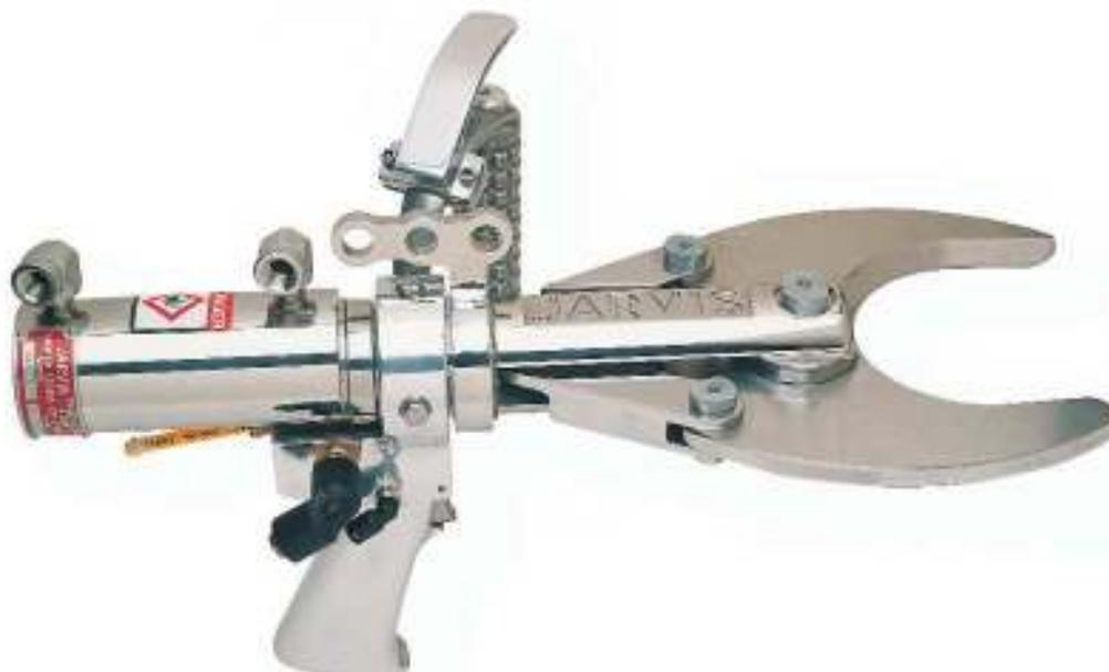
Рис. 2.158. Ножницы для удаления конечностей
