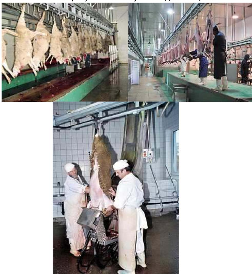
Рис.2.156 Шкуротъемка для овец. Вертикальное обескровливание
