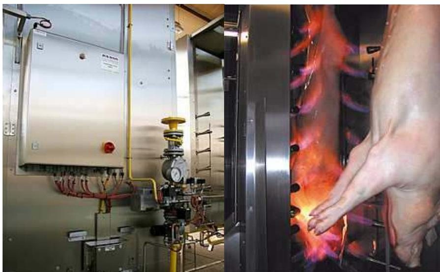
Рис. 2.142. Печи для опалки свиных туш
