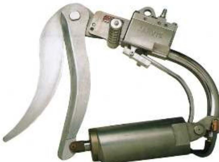
Рис. 2.159. Пневматический секатор для разрезания грудины овец
