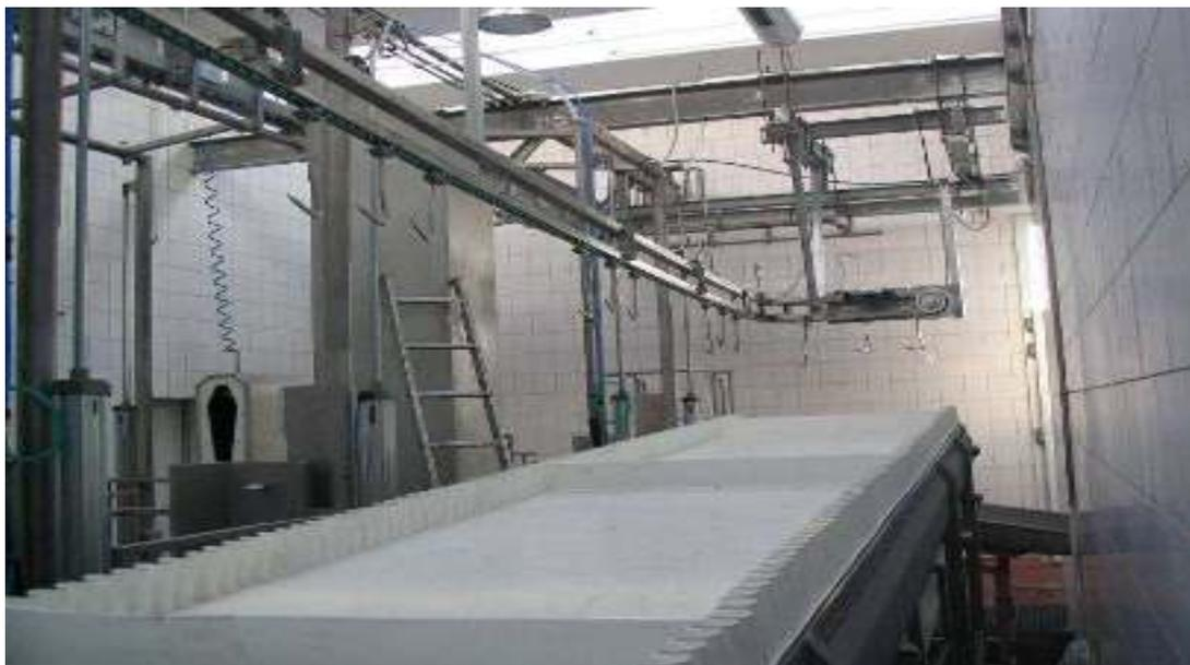
Рис. 2.114 Конвейер для транспорта голов и субпродуктов
