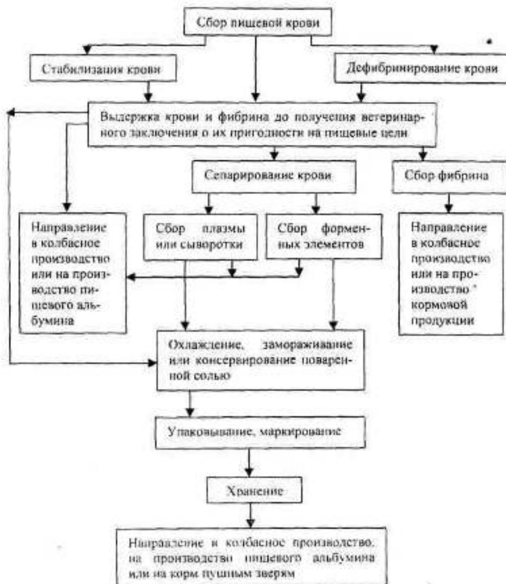
Рис. 2.48 Технологическая схема сбора и переработки пищевой крови
