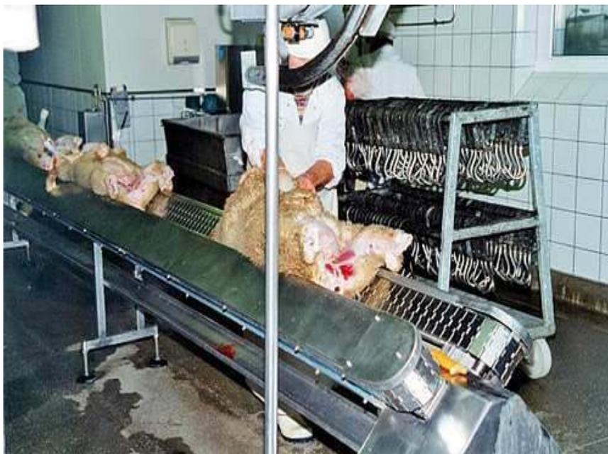
Рис.2.157. Конвейер забеловки овец
