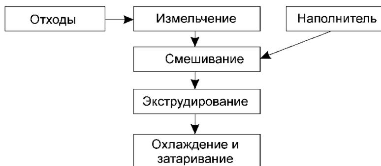
Рис. 2.69 Технология экструзионной переработки отходов мясоперерабатывающих предприятий
