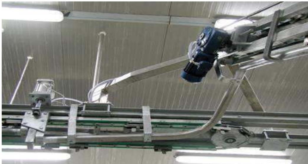
Рис. 2.117. Подвесной конвейер
