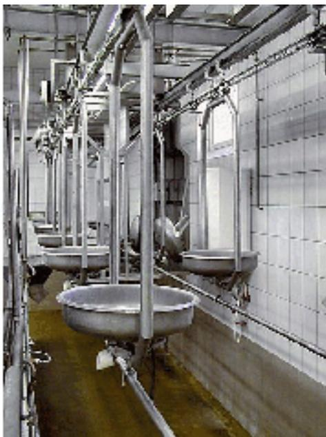
Рис. 2.145. Поддонно-крюковой транспортер
