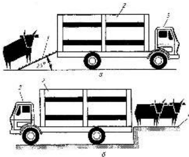
Рис. 2.1. Схема загрузки крупного рогатого скота в скотовозы:
