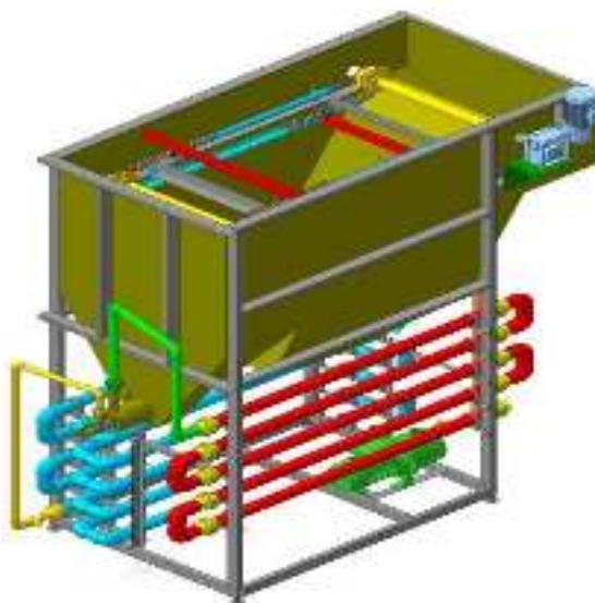
Рис. 2.87 Напорный реагентный флотатор НРФ-2
