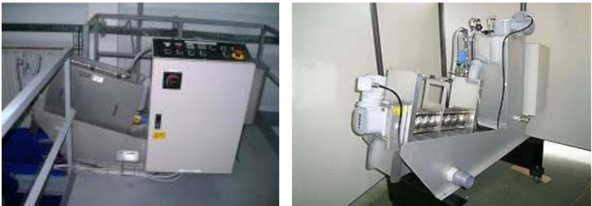
Рис. 2.84 Шнековый дегидратор (общий вид).
