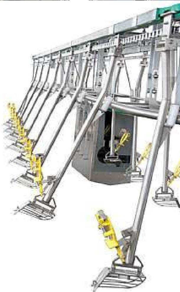
Рис. 2.174. Оборудование для гигиены рабочих на входе в убойный цех
