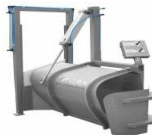
Рис. 2.122. Пневматический бокс для оглушения свиней
