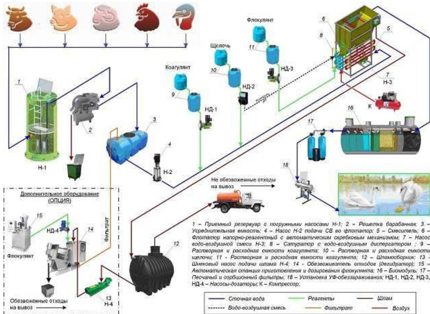
Рис. 2.86 Принципиальная схема ЛОС мясоперерабатывающего производства малой мощности
