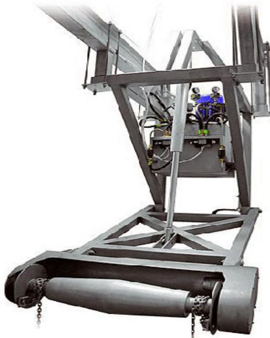
Рис. 2.110 Гидравлическая шкуроеъемка
