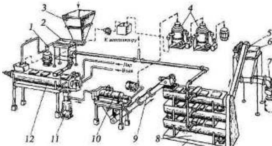
Рис. 2.66 Схема установки предварительной варки и обезжиривания непищевого сырья
