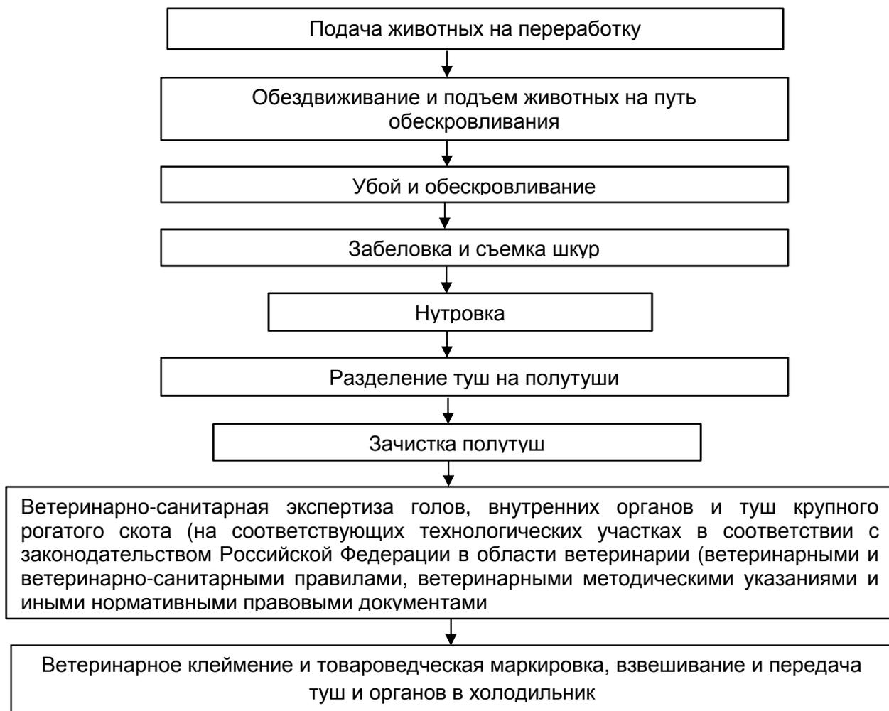
Рис. 2.3. Технологическая схема переработки крупного рогатого скота.
