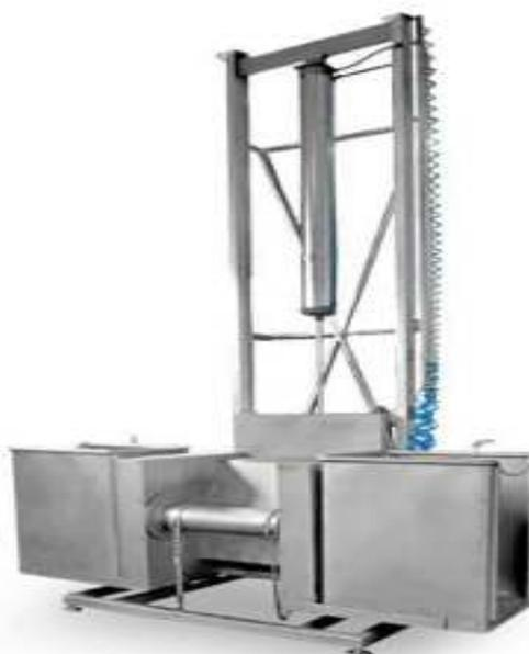
Рисунок 2.118. Пневматическая шкуротъемка
