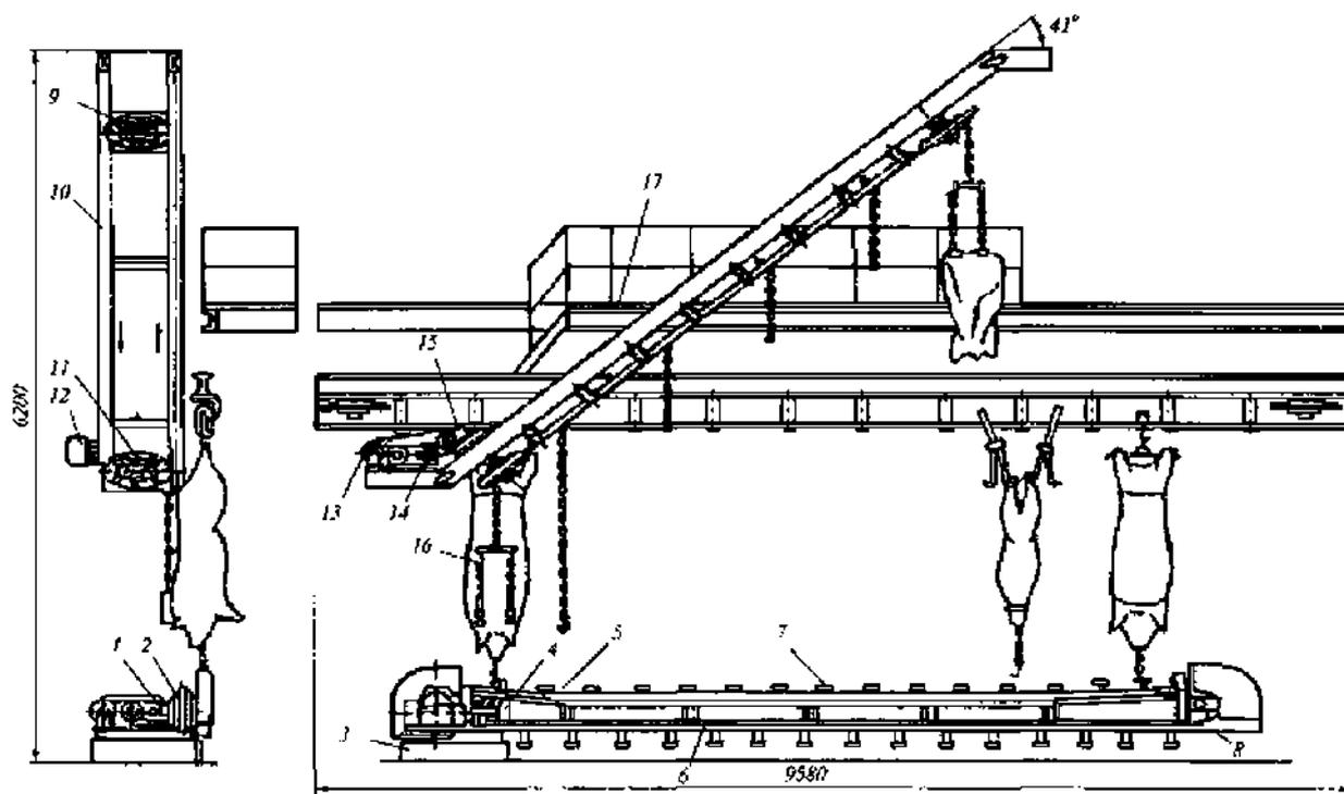
Рис. 2.16 Установка Г2-ФШН для съема шкур с туш свиней
