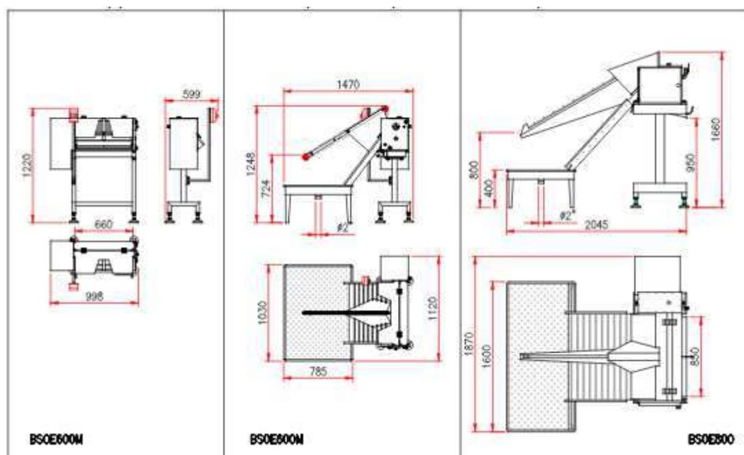
Рис. 2.170. Шлямодробильная машина
