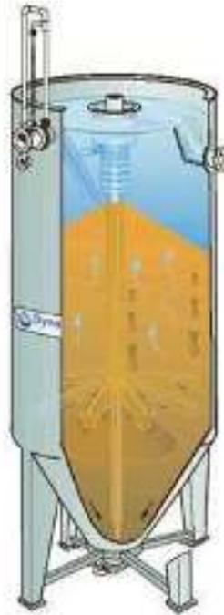
Рис. 2.81 Самопромывной песчаный фильтр (конструкция).
