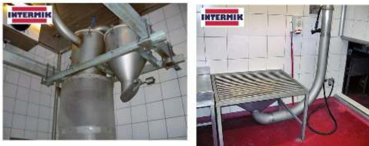
Рис. 2.116 Устройство для транспортирования отходов
