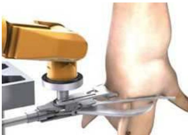
Рис. 2.151. Отделение головы свиней гидравлическими ножницами
