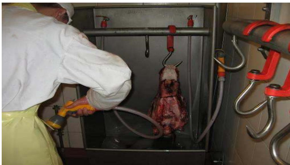
Рис. 2.111 Устройство для мойки голов
