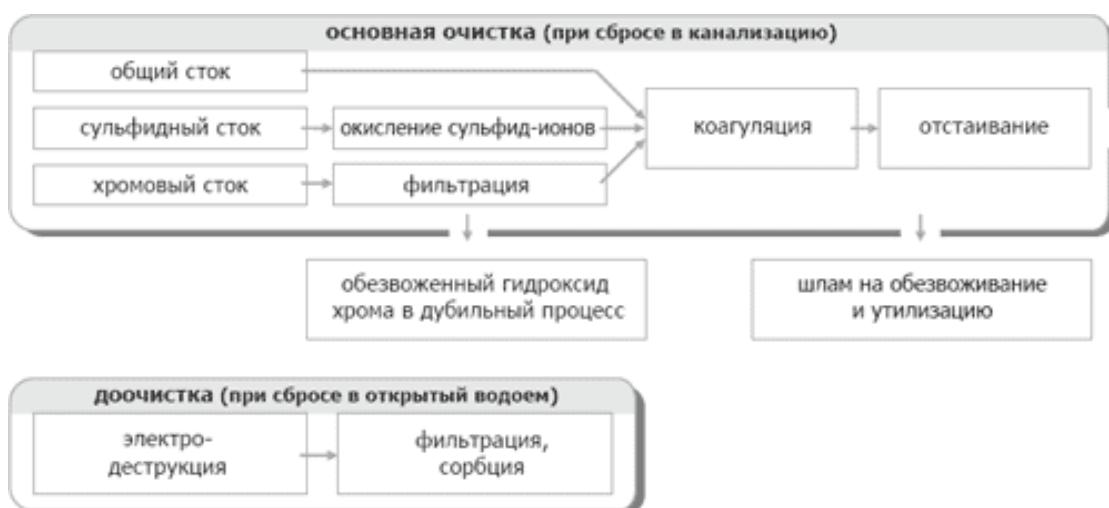
Рисунок 4.3 — Схема физико-химической обработки стоков
