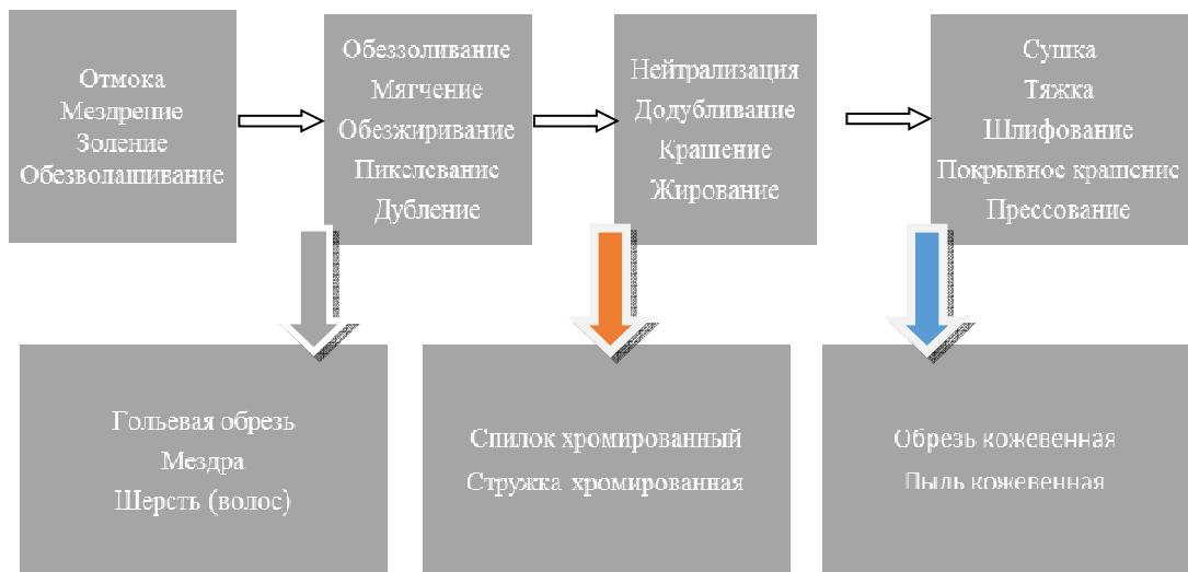
Рисунок 2.4 — Схема образования побочных продуктов в технологическом процессе
