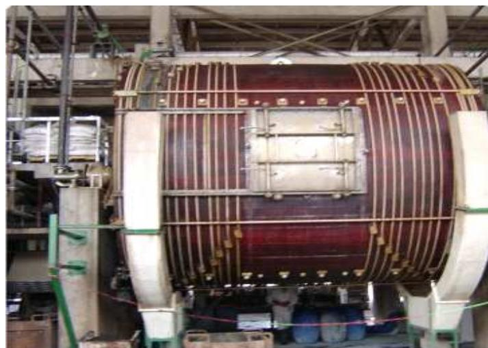
Рисунок 2.2 — Барабан для отмочно-зольных процессов
